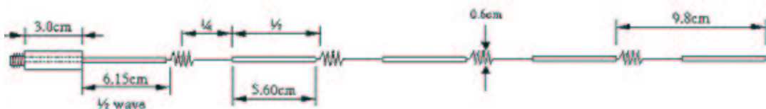
Diagrama general de la antena y medidas.
